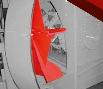
Ouverture facilitée de la turbine sur toute la hauteur.
