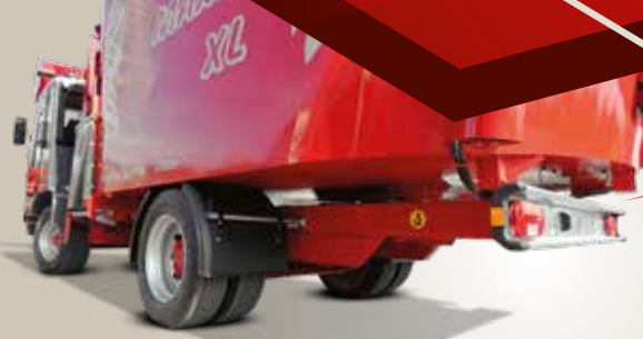
Roues arrière jumellées sous la caisse.
