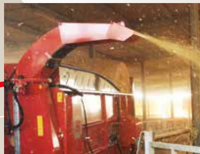
Goulotte universelle à gauche avec orientation à 300°.
