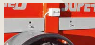
En option: • La commande latérale porte et tapis, installée sur le côté de la machine, permet d'optimiser les opérations de chargement. • Garde-boues.
