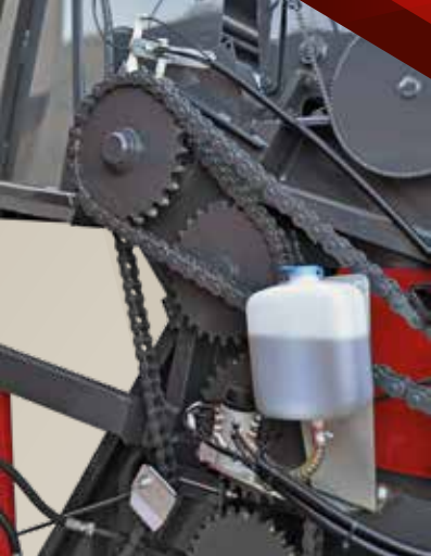
Lubrification automatique des chaînes. (Option)
