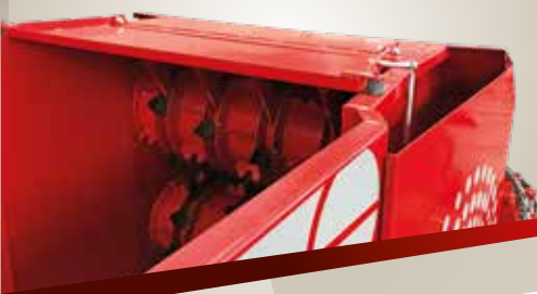
Dispositif autorégulateur de l'avancement du tapis. Système « Anti-Crash ».
