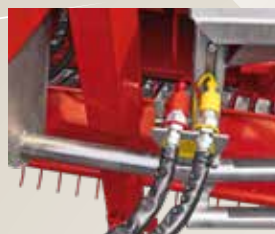
Hydraulique tracteur: 1 SE relevage du ramasseur 1 SE ouverture et fermeture de la porte.
