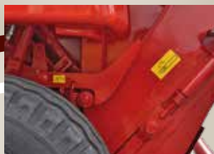
La porte arrière verrouillée permet d'augmenter la densité des balles, l'ouverture se fait par l'intermédiaire de deux vérins simple effet, tandis que la fermeture est assurée par deux crochets mécaniques.
