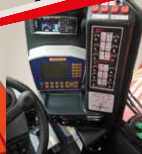
Vue d'ensemble du poste de conduite. Marche avant / arrière au pied. Mono-levier pour les commandes principales.
