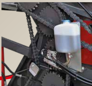
Lubrification automatique des chaînes. (Option)
