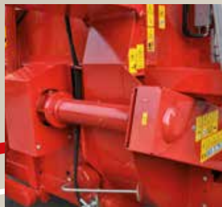
Sécurité à cames NON-STOP à bain d'huile sur le démêleur. (Patinage en présence de corps étrangers).
