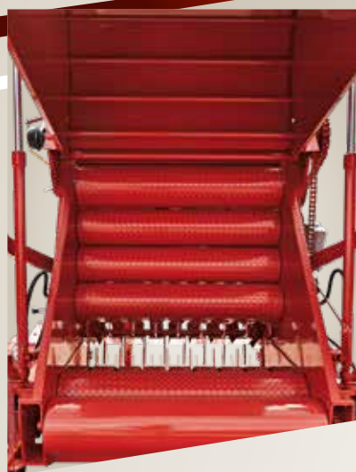
Système mixte, rouleaux+barrettes évitant de débrayer la prise de force à chaque ouverture de porte. Les deux rouleaux inférieurs sont décalés afin de faciliter la sortie des bottes.
