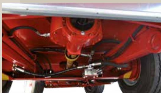
Deux pompes hydrauliques "Linde" avec fi ltre incorporé, Une pour la rotation de la fraise de chargement et de la turbine de paillage (à gauche) et l'autre pour l'avancement hydrostatique du pont arrière (à droite).
