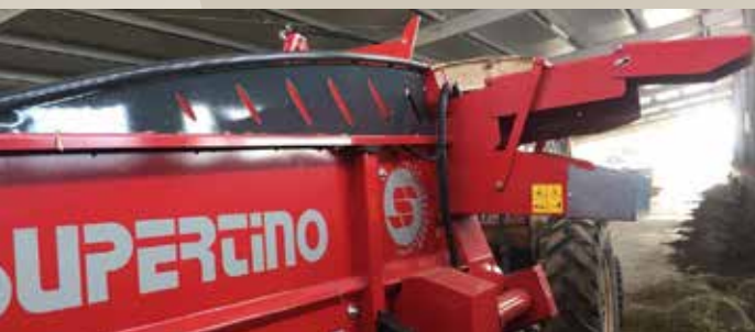
Goulotte de série à droite à commande hydraulique.
