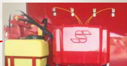
Kit antipoussière permet de diminuer sensiblement la poussier lors de la distribution des produits secs. Capacité de 50 litres avec 4 buses (option).
