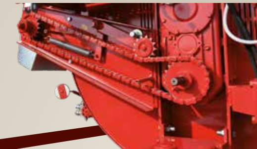
Transmission à chaîne à tension automatique. Transmet 100% de la puissance.
