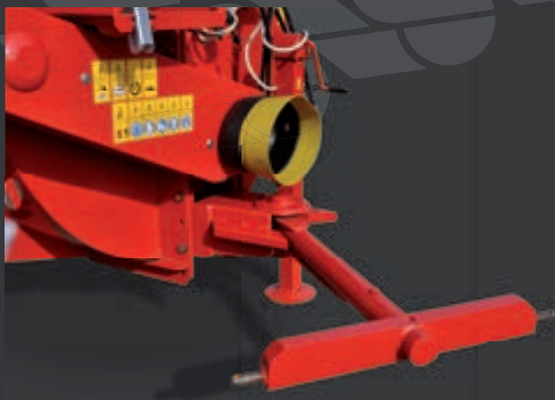
Timon articulé afin de faciliter les manœuvres dans les conditions difficiles d'accès.
