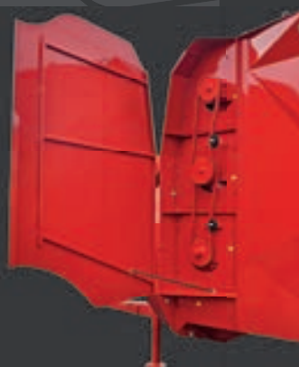
Transmission mécanique aux rotors démêleurs par chaîne.
