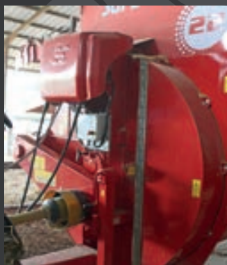
Ouverture facilitée de la turbine sur toute la hauteur.
