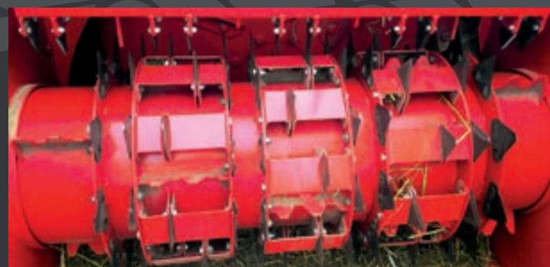
Kit supplémentaire de 27 couteaux sur le rotor démêleur.
