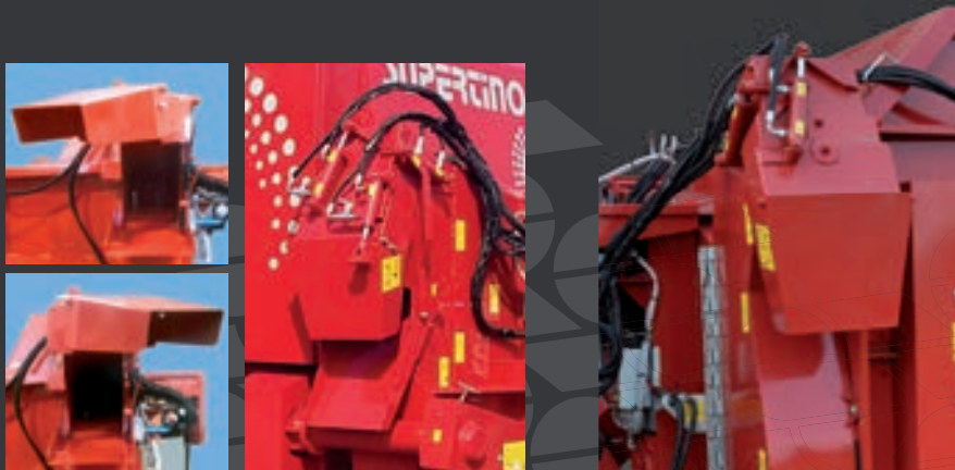
Commande hydraulique de la casquette avec orientation de 45° avant et 45° arrière de la goulotte d'origine. Deuxième goulotte à gauche (option) avec orientation de 45° avant et 45° arrière.
