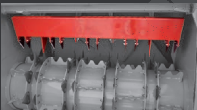
Doseur de flux à 10 couteaux sur le démêleur.
