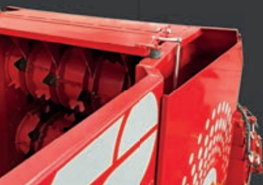
Dispositif autorégulateur de l'avancement du tapis. Système « Anti-Crash ».
